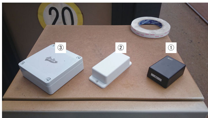
〈図2-1. 電停に設置したビーコン〉
